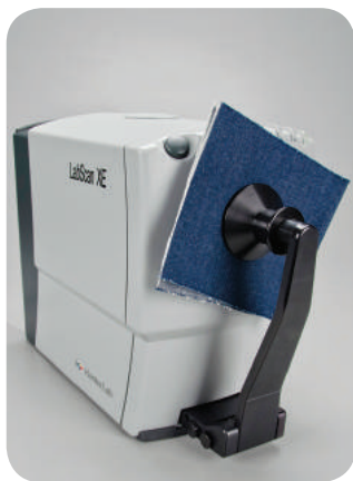
测量口朝前，样品夹抵住样品
